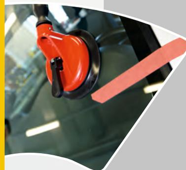
Il est conseillé de vérifier la précision d'ajustage et l'absence de défauts sur le nouveau pare-brise avant le nettoyage. Insérer une entretoise et marquer la position correcte de le pare-brise avec du ruban adhésif.
