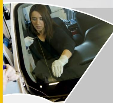
Retirer les moulures de décoration, joints et essuie-glaces conformément aux indications du constructeur du véhicule. Extraire le pare-brise endommagé à l'aide d'un fil de fer coupant ou d'un couteau spécial. Retirer le pare-brise endommagé avec des poignées à ventouse.
